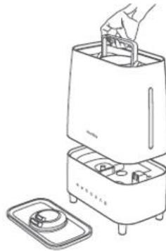
3. Retournez le réservoir d'eau et dévissez le bouchon du réservoir d'eau en le retirant du réservoir d'eau. Le filtre à carbonate de calcium sera fixé au bouchon du réservoir d'eau.
