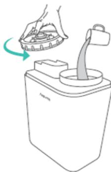
4. Remplissez le réservoir d'eau avec de l'eau, revissez le bouchon du réservoir d'eau et remettez le réservoir en place sur la base. Le niveau du réservoir d'eau peut être vu à travers le hublot sur le côté gauche.
