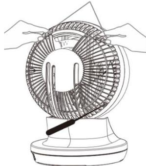
2. Drücken Sie vier Verriegelungen zusammen, um das vordere Schutzgitter wegzuziehen. An der Vorderseite der Ventilatorblätter befindet sich eine Mutter - schrauben Sie die Mutter ab, um die Rotorblätter zu entfernen.
