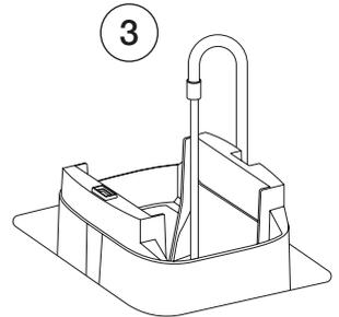
Entfernen Sie die obere Abdeckung des Wasserbehälters, stellen Sie den Wasserbehälter in ein Waschbecken und füllen Sie den Behälter direkt mit dem Wasserhahn.
